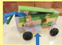
タイヤにぶつかってブレーキの役割を果たす…と考えて付ける
